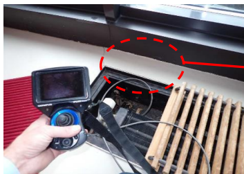
Afb 7. Aanzicht endoscopisch onderzoek onder de pui.
